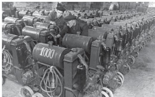
*Прожекторный завод им. Кагановича, принявший обязательство выполнить пятилетку в два с половиной года. На снимке готовые колхозные электростанции мощностью полтора квт на испытательной станции завод. 1948 г.
