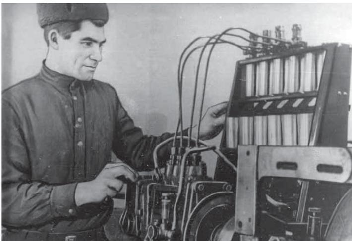
*Богекорн Г.И., комбайнер Еланской машино-тракторной станции Усть-Таркского района, выполняющий по две нормы в смену на ремонте топливной аппаратуры дизельных моторов. 08 декабря 1956 г. (Автор снимка Б. Шумаков).*
