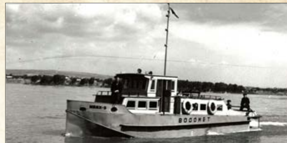
Буксирный катер МБКХ-5 с водометным движителем мощностью 90 л.с., освоен серийным производством в 1952 г., построено 212 единиц. КГКУ «ГАКК». Ф.П-7835. Оп.8. Д.126. Л.18
